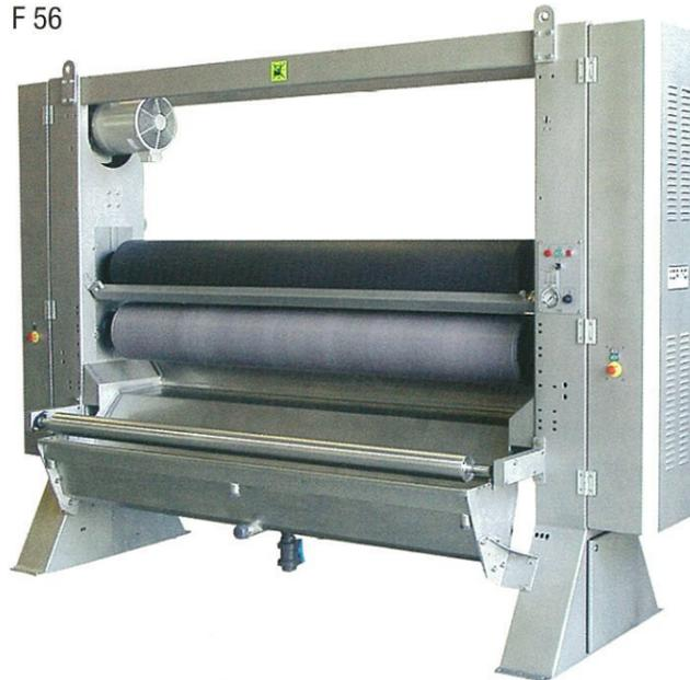
La struttura della macchina si presenta robusta, snella e compatta; facili le operazioni di pulizia, manutenzione, smontaggio cilindri. Può essere costruita interamente in acciaio inox e può alloggiare diversi sistemi guida tessuto.
